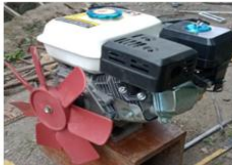
Gambar 3. Motor penggerak yang sudah dipasang kipas (blower)
